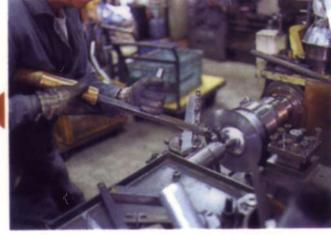
金属板を回転する型にあて、へらで押さえる（絞る）と、ろくろの原理で金属板はみるみる変形していく。てこの原理で、へらが長いほど強い力が加わるので、硬い金属ほど長いへらを用い、軟らかい金属は短く持つ
