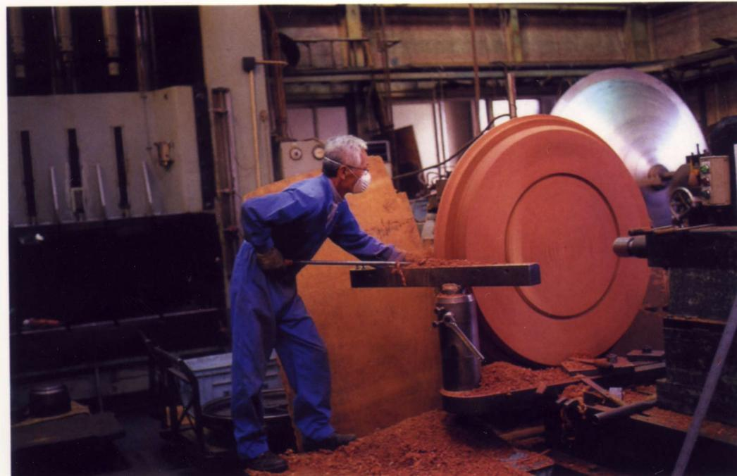
大型物は木で型をつくる。木の伸び縮みを調整しながら正確な型をつくる「木工」の仕事も、金属絞りのための大事な仕事のひとつ。右後ろに見えている金属はパラポラアンテナである
